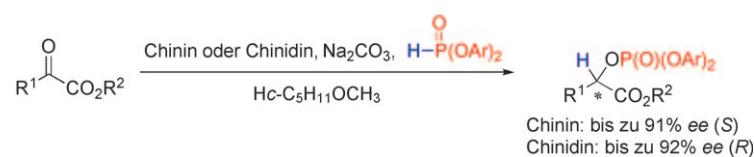
**Phosphonate jetzt auch chiral:** Die organokatalytische enantioselektive Reaktion von  $\alpha$ -Ketoestern mit Phosphiten in Gegenwart von Chinaalkaloiden und  $\text{Na}_2\text{CO}_3$  führt mit hohen Enantioselektivitäten zu  $\alpha$ -Phosphonyloxyestern (siehe
